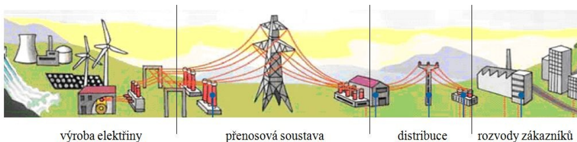
Obrázek F14-1: Rozvodná zařízení
