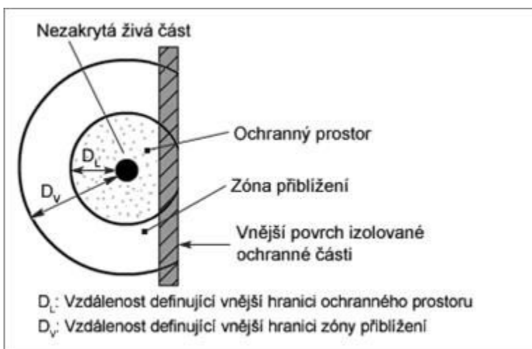
Obrázek D1-2: Vzdušné vzdálenosti a zóny pro pracovní postupy
