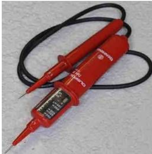
Obrázek E3-1: Zkoušečka nn
